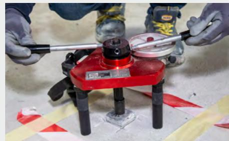
© Photo 3 : Essai de traction perpendiculaire
