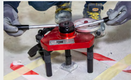
© Photo 3 : Essai de traction perpendiculaire Source : ESOLIA
